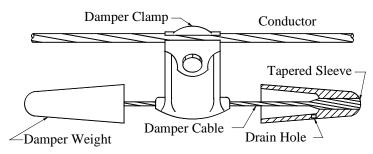
FIGURE 15-11: TYPICAL SUSPENSION DAMPER
