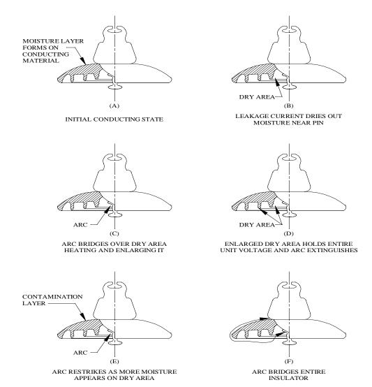
FIGURE 8-5: CONTAMINATION BREAKDOWN PROCESS OF A SINGLE CERAMIC INSULATOR UNIT
