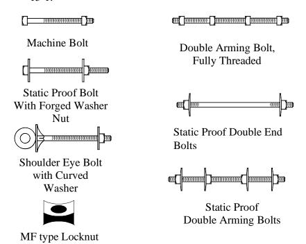
FIGURE 15-14: FASTENERS
