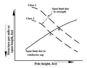
FIGURE 13-1: SELECTION OF LEVEL GROUND SPAN
